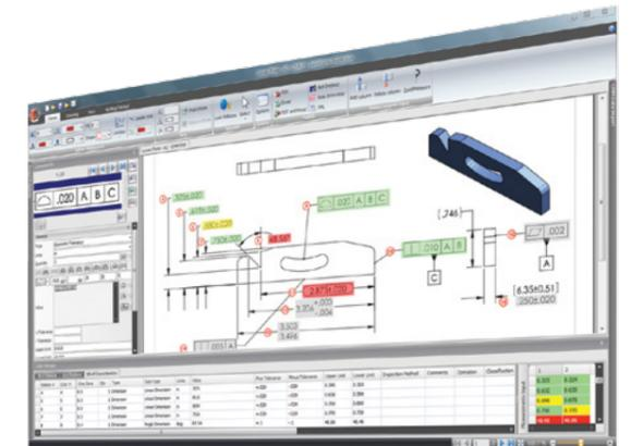
Las características se resaltan automáticamente en verde, rojo o amarillo para mostrar al instante las que se encuentran en tolerancia, fuera de tolerancia o ligeramente en tolerancia.
